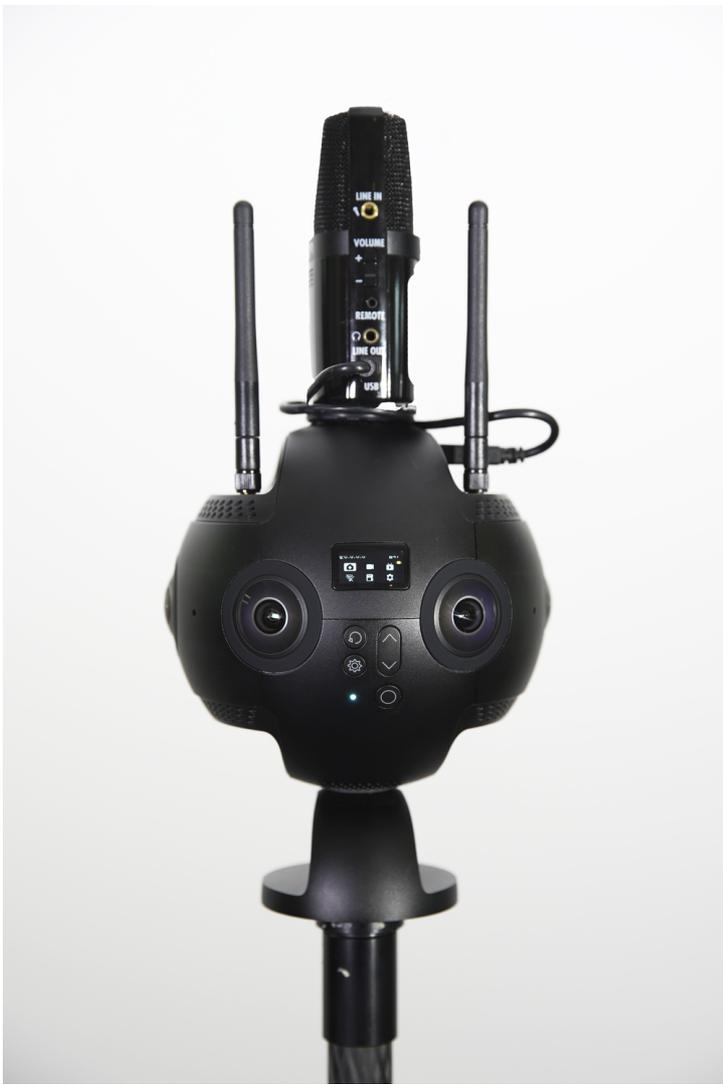
2. 将 H2N 通过 USB 连接线与 Pro 2 相连接，设置好 H2N 的 USB 全景声录制模式，之后操作 Pro 2 正常的录像、直播即可。使用之前请确保 H2N 的程序固件已更新至最新的版本。
