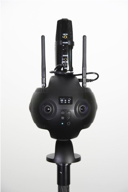
2. 将 H2N 通过 USB 连接线与 Pro 相连接，设置好 H2N 的 USB 全景声录制模式，之后操作 Pro 正常的录像、直播即可。使用之前请确保 H2N 的程序固件已更新至最新的版本。
