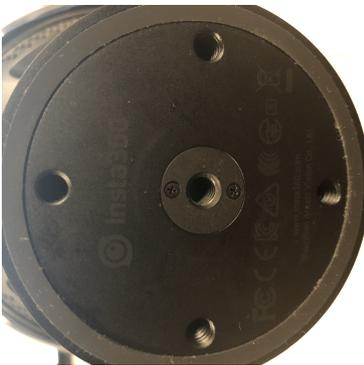
(Der zentrale Montagepunkt verfügt über einen Adapter für 1/4" und 3/8" Gewinde)
